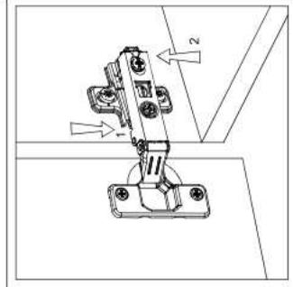
1. ENGAGER LA CHARNIÈRE AVEC LES CROCHETS À L'AVANT DE LA PLAQUE DE MONTAGE.
