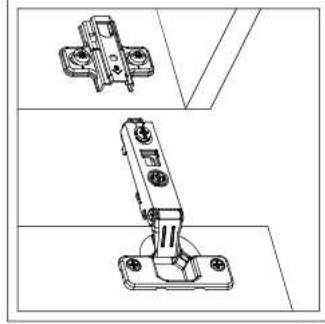
FIXATION DE LA CHARNIÈRE ET DE LA PLAQUE DE MONTAGE À L'AIDE DES VIS À TÊTE FRANSÉE.
